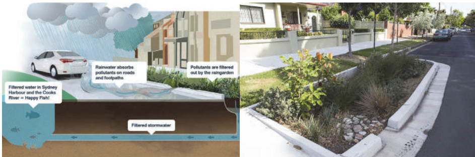
[그림 3-30] 시드니 빗물정원 작동방식과 예시
